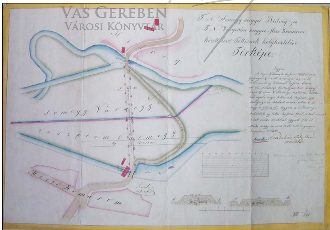
4. ábra: Töltésépítés / Hídvég és Mezőkomárom között, 1863.
